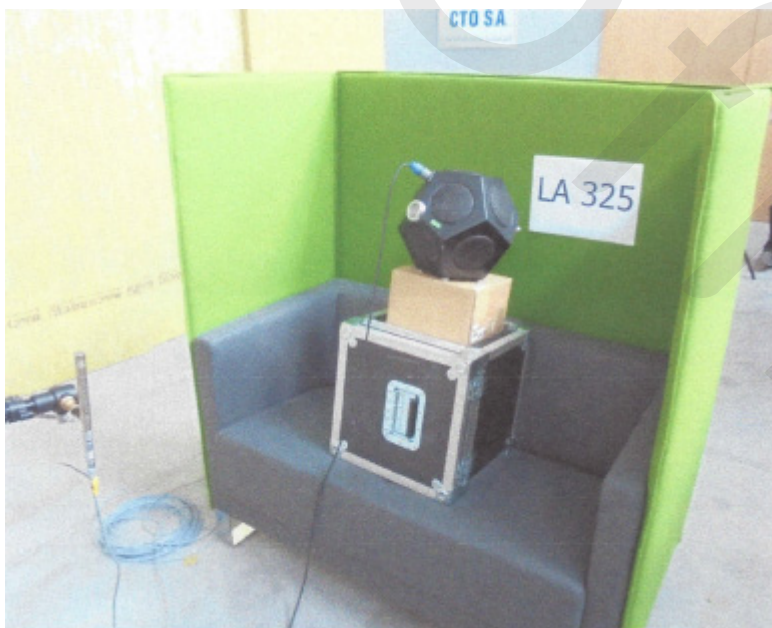
Abb. 5. Lokalisierung der Schallquelle auf der Höhe von 110 cm.
