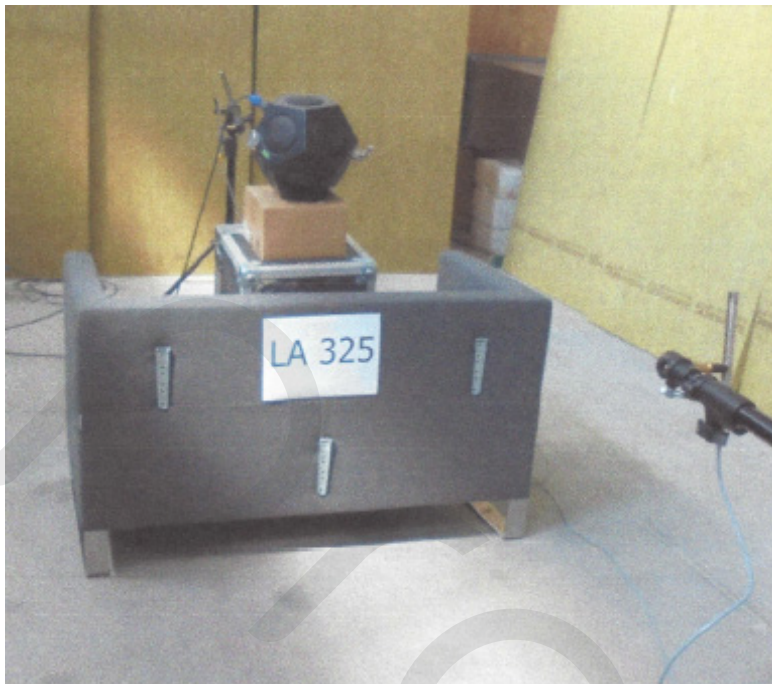
Abb. 4. Aufstellung des Mikrofons 140 cm von der Sofa ohne Paravent entfernt.
