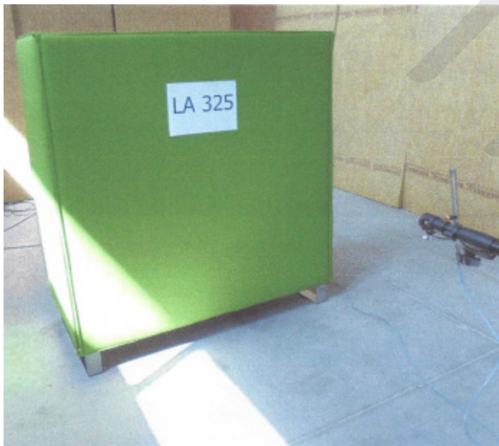
Abb. 3. Aufstellung des Mikrofons 140 cm vom Paravent entfernt.
